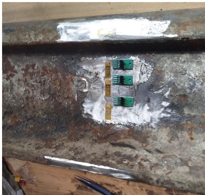
Рис. 2 – Испытательный рельс с наклеенными тензорезисторами в срединном пролете между шпалами, также на подошве и головке
