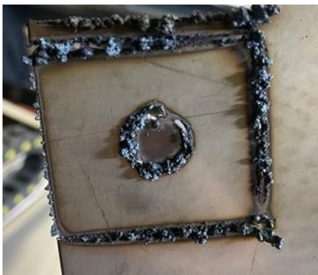
Рисунок 1 – Вырез детали при скорости станка в 2000 мм/мин
