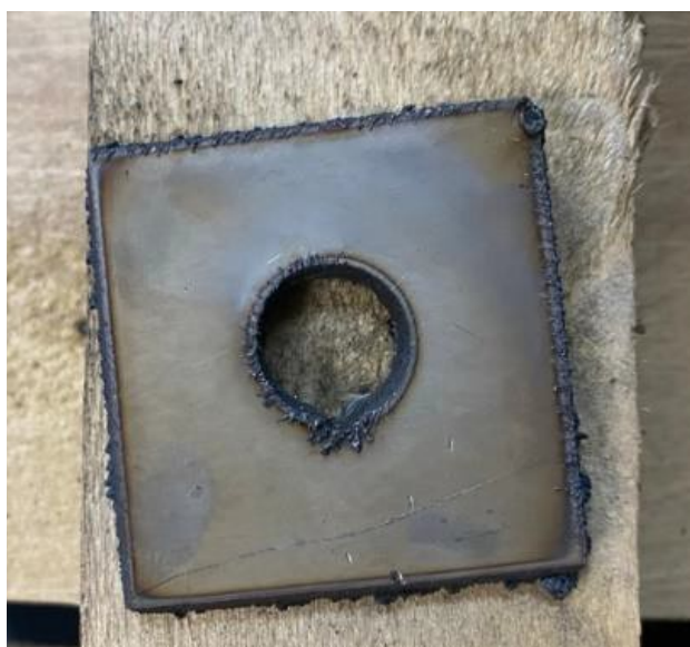
Рисунок 2 – Вырез детали при скорости станка в 1300 мм/мин
